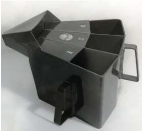
Der Aufgiesstopf besteht aus 3 Abteilungen. Abteilung Ä (links) nimmt die Ätzkalilösung auf, die Silberlösung wird in Abteilung S (Mitte) eingefüllt und rechts befindet sich das Abteil R mit der Reduktionslösung.
